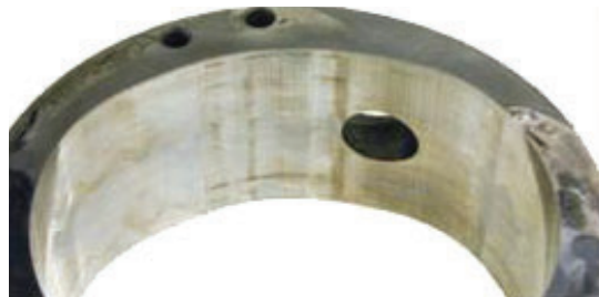
一类基础油中添加HiTEC® 523, 经Parker T6H20C湿式泵实验测试后的定子
